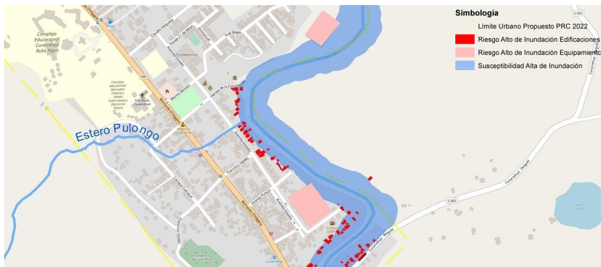
Figura 28. Riesgo Alto de Inundación en Sectores del Estadio Municipal y Municipalidad
